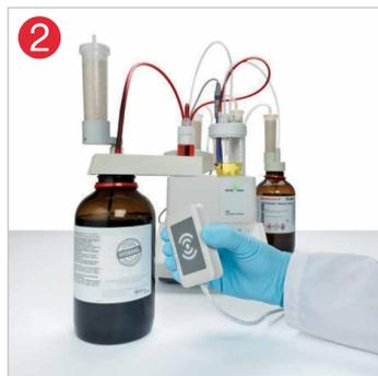
2 SmartLabel-Daten auslesen. Halten Sie das Lesegerät unterhalb des ursprünglichen Hydranal-Stempels, an die Stelle wo sich das SmartLabel befindet.
