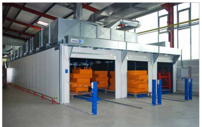
Lackiererei mit Trocknungsstraße
