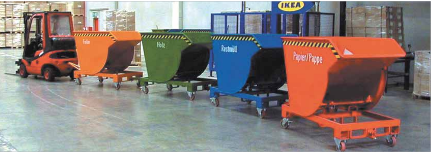
BKM mit Rollen und Anhängervorrichtung mit Deichsel
