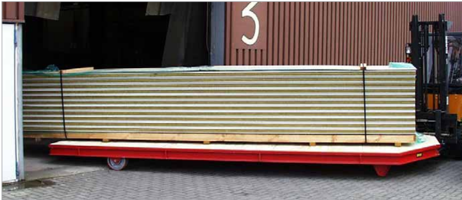
Transport von Langgütern; kleiner Wendekreis durch Direktaufnahme
